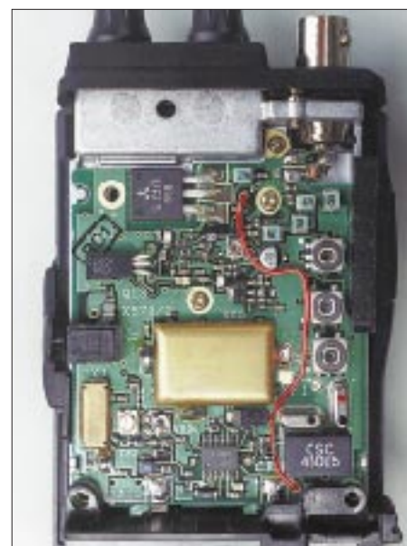
Ein Blick ins Innere, hier auf das HF-Teil. Für Kühlung sorgt ein Druckgußrahmen zwischen den Leiterplatten.
