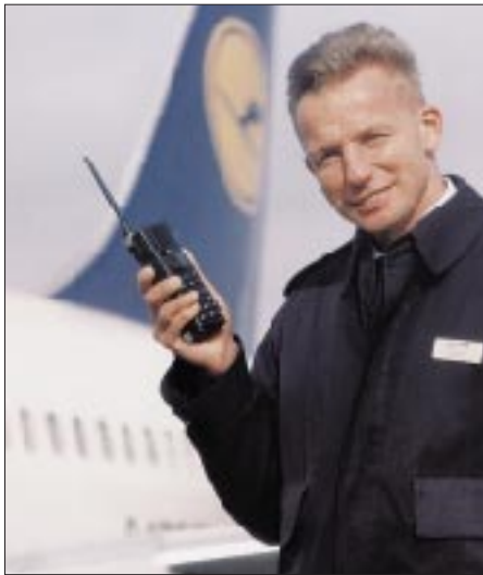
Eins für fünf: Das Handfunksprechgerät UFH 971 ist für Mobilfunk, Betriebsfunk, Telefonie, Pagerdienste und Datenkommunikation nutzbar.
