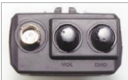
Die Oberseite teilen sich BNC-Buchse, Lautstärksteller und Abstimmknopf.
